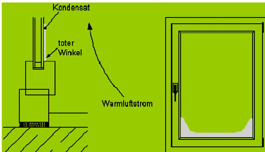
Eine Verminderung der Kondensatbildung kann auch durch eine Änderung der Wärmeluftführung bzw. durch eine günstige Anordnung der Heizkörper erreicht werden. Der Wärmeluftstrom soll möglichst dicht am Fenster entlang streichen, so dass höhere Wärmeübergangskoeffizienten möglich sind. Bei vorhandenen Einbauten kann durch Schlitze in den inneren Fensterbänken die Kondenswassergefahr herabgesetzt werden.
