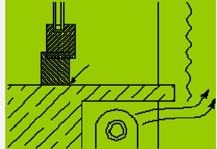
Tauwassergefahr verringert sich durch am Fenster entlangstreichende Warmluft vom Heizkörper. Dadurch erhöhen sich u. a. die Oberflächentemperaturen am Fenster. Tauwassergefahr erhöht sich, da eine große Einbautiefe vorhanden ist und deshalb durch mangelnde Konvektion im Bereich Blendrahmen/Mauerwerk sogenannte "tote Winkel" entstehen. Damit sinkt die Oberflächentemperatur.
